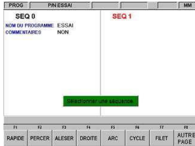
FIGURE 7.8.1 L'écran de titre est complet et se trouve à gauche. Sélectionner un type d'événement à l'aide des touches logicielles.
