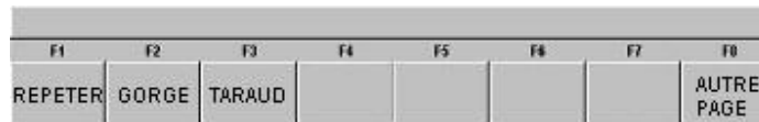
FIGURE 7.8.2 Appuyer sur la touche AUTRE PAGE (F8), et les touches logicielles se transforment pour afficher le reste des événements disponibles.
